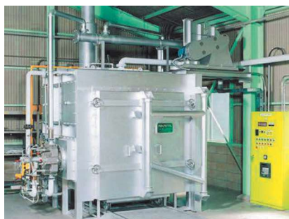
入熱200 kW/h 加熱炉(工業炉) (H 2 /NH 3 最適比，バーナ最適化)
