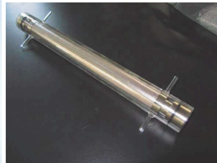
図 プラズマメンブレンリアクターの外観 (高電圧電極をはずした状態，長さ400 mm，外径50 mm)
