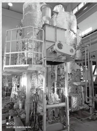
写真2 未利用資源のガス化試験プラント
